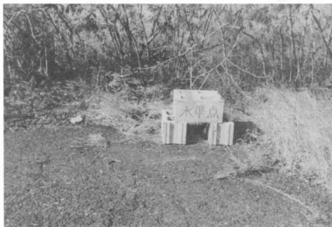
写真4 水準点・設置機関不明ではあるが、後日のために保護石を積む(阿蘇台断層の南約200mの十字路)
