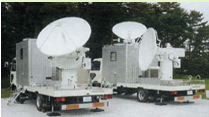
防災科研の新マルチパラメータレーダーシステム。右：降水観測用（波長3 cm）、左：雲観測用（波長8 mmと3 mmの2周波）。機動的な観測を行うために、普通免許で運転可能な4トントラックに搭載されています。降水観測用レーダーには衛星通信装置が備えられており、取得データの即時伝送が可能です。
