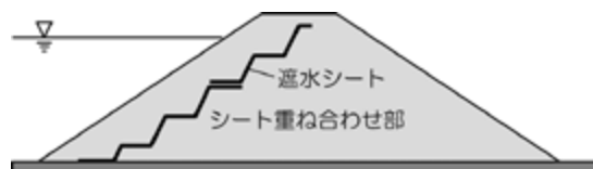
図1 階段状敷設断面
