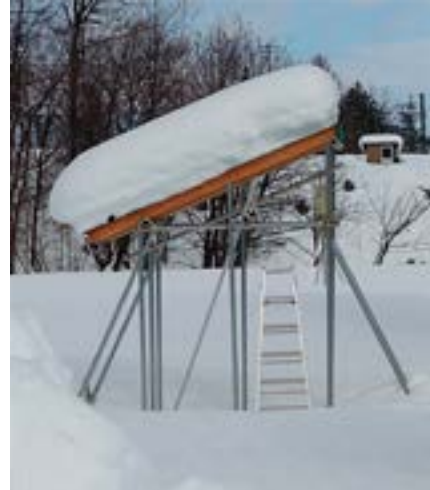
図3 屋根雪荷重による試験屋根の垂木のたわみを計測する実験の様子（2017年1月）
