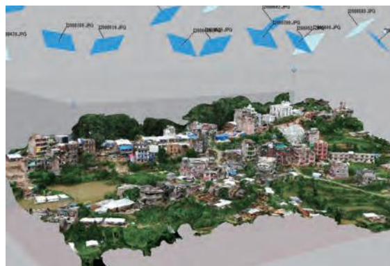
図1 チョータラ市中心部の3次元モデル 上空の四角はカメラの位置
