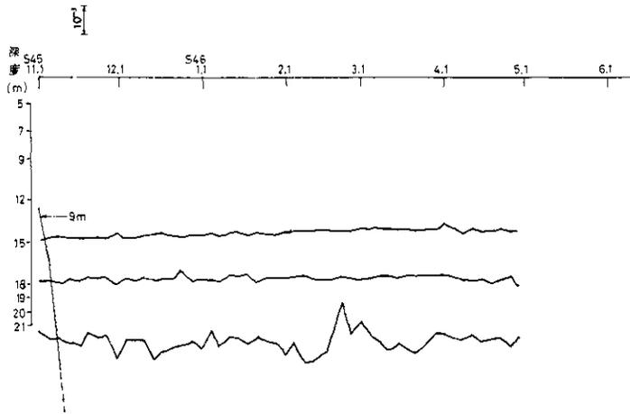
図-4.5.b ひずみ計観測結果(ひずみ量日変化図)
