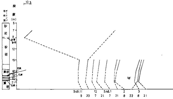
図-4.5.a ひずみ計観測結果(ひずみ柱状図)
