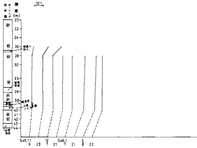
図-4.3.a ひずみ計観測結果(ひずみ柱状図)
