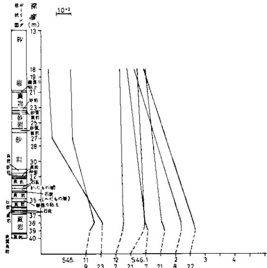
図-4.7.a ひずみ計観測結果（ひずみ柱状図）
