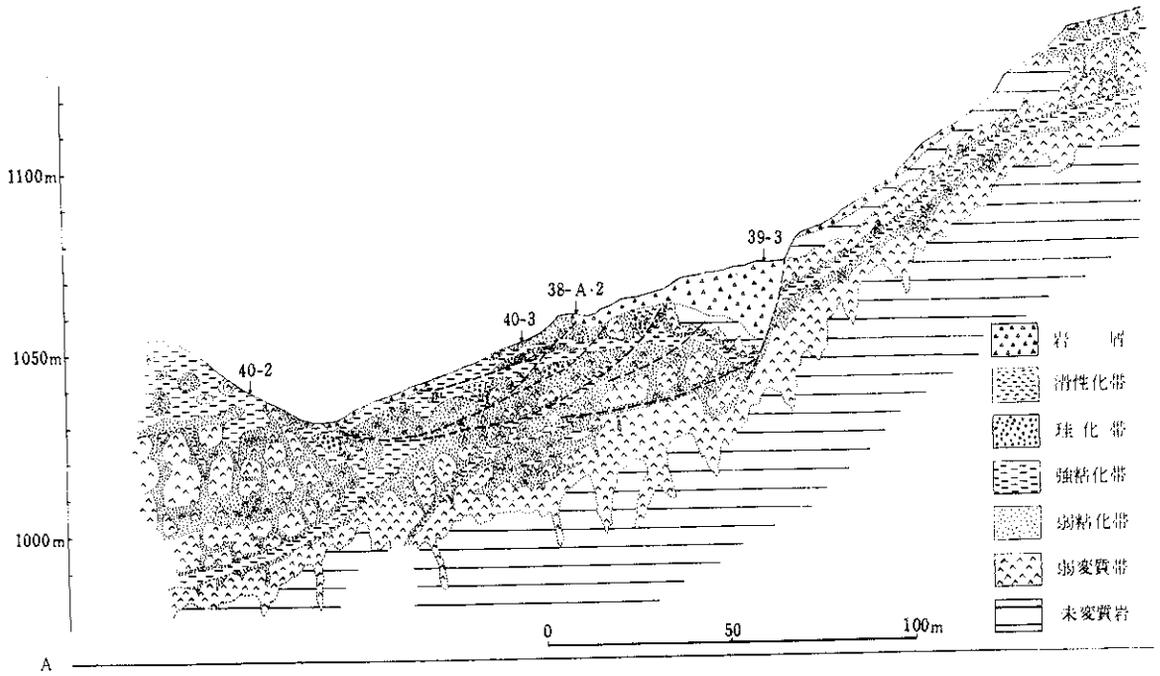
図—8 大涌谷変質帯断面図
