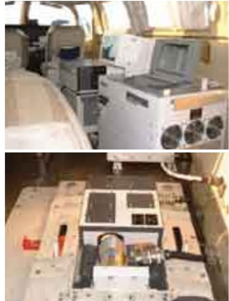
写真 1 航空機に搭載した VAM-90A 制御監視装置ユニット (写真 1 上) と走査検出器ユニット (写真 1 下) 観測準備中のため検出器の一部は未装着。
