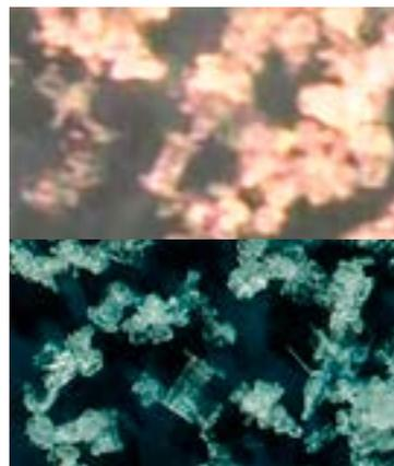
写真3 降雪粒子連続撮影装置により撮影された画像（縦横3mm×5mmで切り出し）
