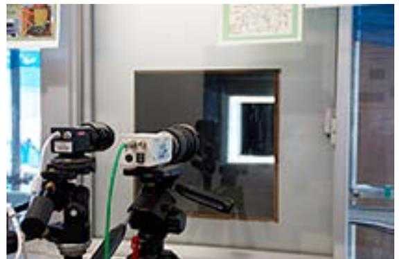
写真2 CCDカメラを用いた降雪粒子観測装置
