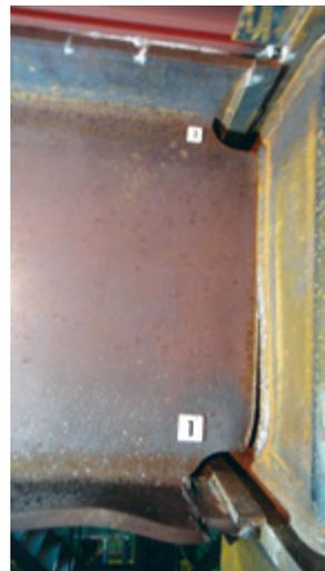
写真2 JR鷹取波で下端フランジが破断した柱(右側)と梁(左側)の接合部
