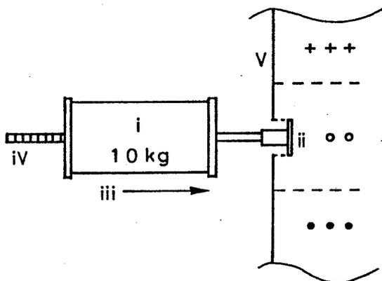
図2 カナディアンゲージの測定法
