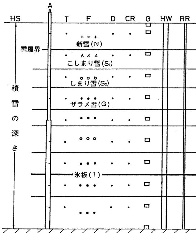
図1 積雪断面観測の順序、項目、位置
