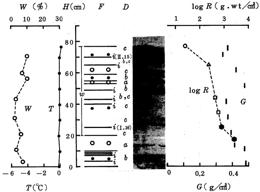
図 2-(11) 積雪断面観測図, 1975年3月14日
