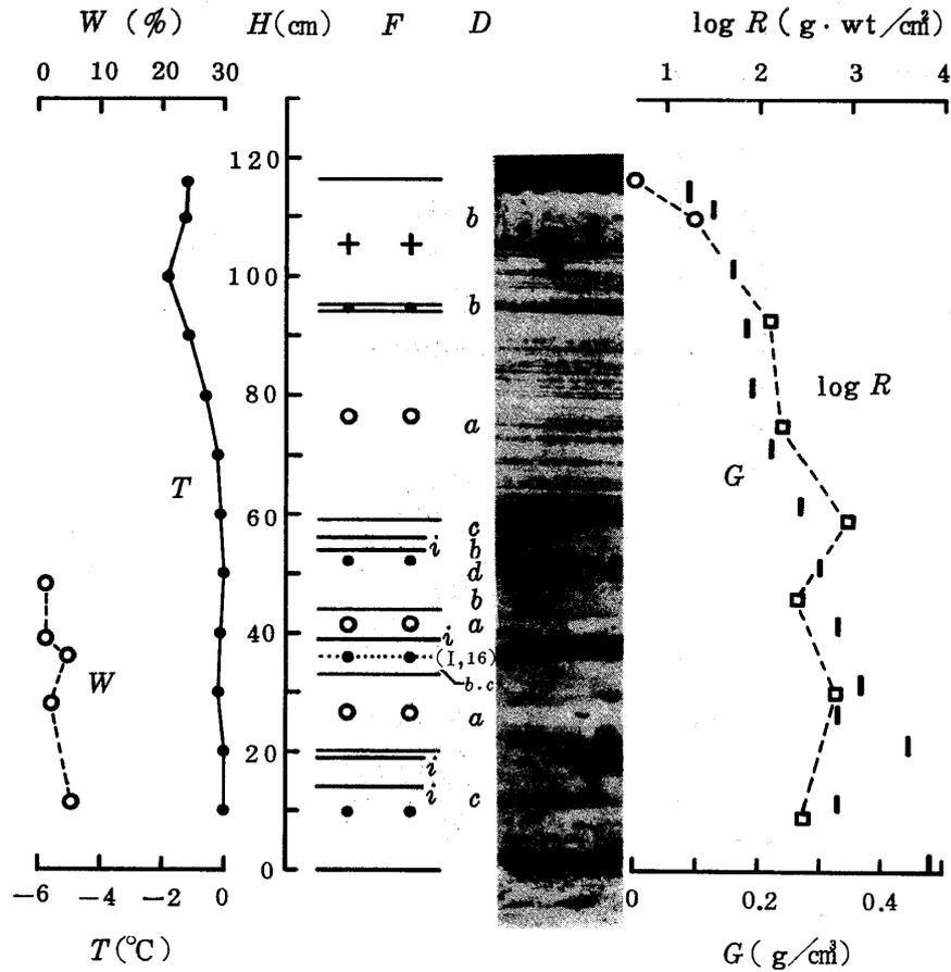
図 2-(8) 積雪断面観測図, 1975年2月15日
