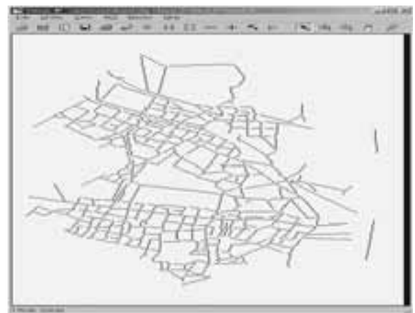
図 12 周回道路部切断により得られた実証試験区域における周回道路のない線画化道路網 Fig. 12 Processed narrow line networks with no loops in the test area.
