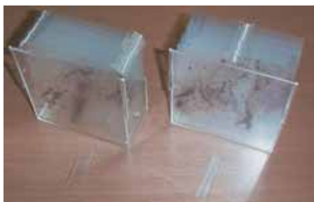
図 8 補助具で糸連結した例。左は角に設置、右は辺の中央に設置した場合で、模型の前は補助具単体を示す。
